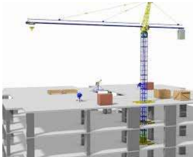
Figura 20: Grua com base do tipo ascensional (Fonte: SANTANA, 2018)
